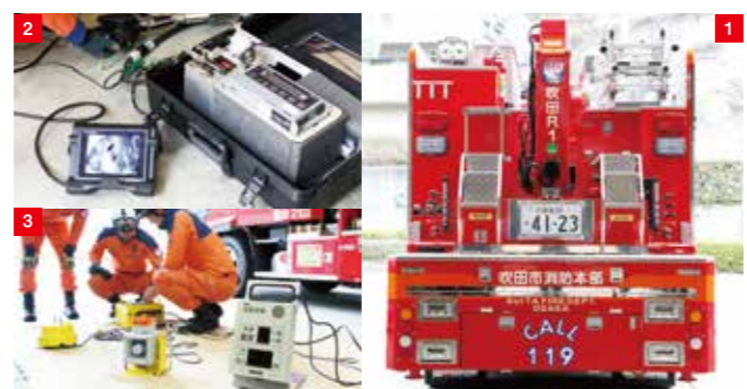
1 救助工作車の後面。室内高も十分に取られ、車内活動空間がしっかりと確保されている 2 画像探索機。胃カメラのような機能に加え、ガスの濃度や温度の測定も可能だ 3 地震警報機。救出活動中の隊員の安全を確保し、二次災害を未然に防ぐ
